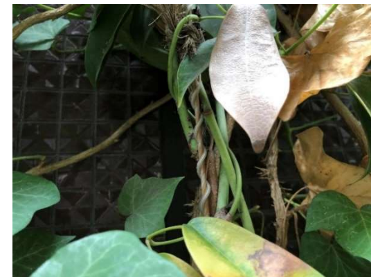
被膜φ6 スパイラルワイヤーセット登攀状況
